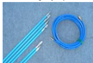
Trykslange og skubbestænger til indføring af packer.
