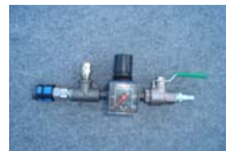
Regulerbar trykluftregulator, med 0,8 bar sikkerhedsventil.
